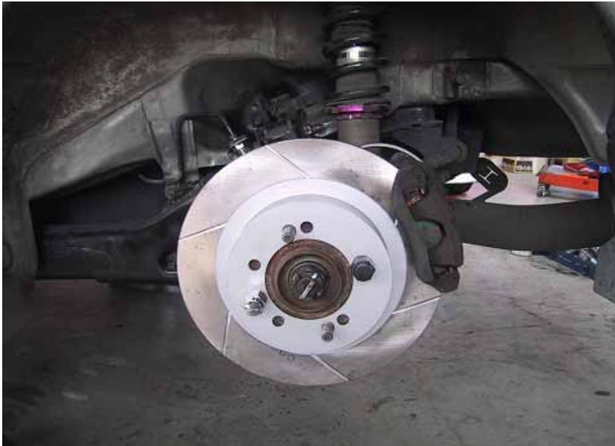
システムを複雑にせずブレーキ強化するためには、キャリパーオフセットが有効。フルタイム4WDとしては、比較的車輻重量が軽量なので、ローターは、ソリッドタイプ(ベンチレーションなし)でもOK。
