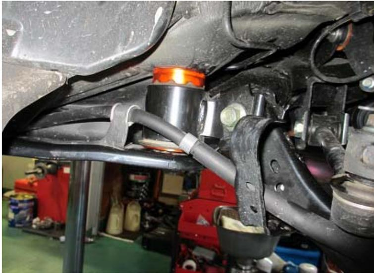
更に、フロント側のブッシュ上側にトラクションスペーサーを付属。この、トラクションスペーサーを入れたり外したりし、トラクション性能を調整できます。純正のスペーサーと併用し、セッティングしてみてください。
