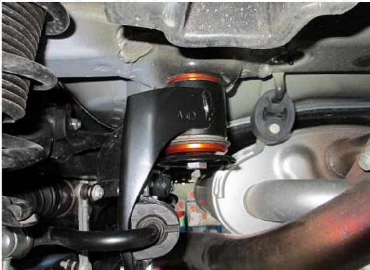
作業的には、サスペンションメンバーの固定ボルトを緩め、ブッシュの上下に専用のカラーを挟み込みボルトを締めるだけです。専用設計された、各場所のメンバーカラーが、純正ブッシュの隙間を埋め、リジット固定により近い固定となります。
