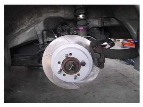
システムを複雑にせずブレーキ強化するためには、キャリパーオフセットが有効。フルタイム4WDとしては、比較的車輌重量が軽量なので、ローターは、ソリッドタイプ(ベンチレーションなし)でもOK。
